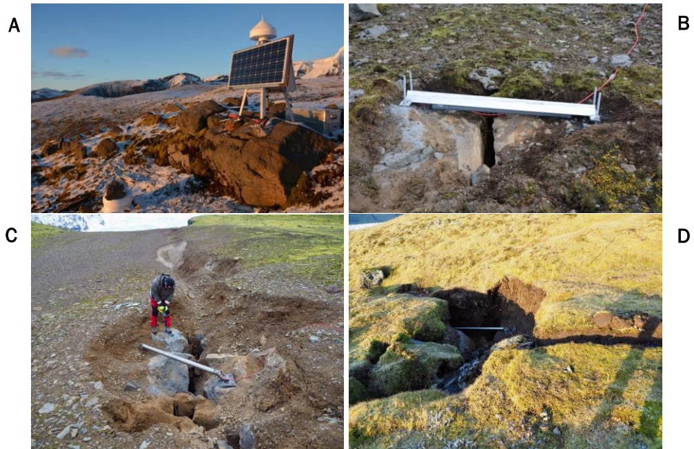
Mynd 10. Tveimur GPS stöðvum og togmælum var komið fyrir á sprungunni árin 2018 og 2019. A: GPS stöð á efri hluta sprungunnar, staðsett SSV af sprungunni í um 850m hæð. B: Togmælir staðsettur á efri hluta sprungunnar í um 850m hæð, komið fyrir árið 2018. C: Togmælir á efri hluta sprungunnar, komið fyrir árið 2019. D: Togmælir á neðri hluta sprungunnar, komið fyrir árið 2019. Munurinn á þykkt lausra jarðlaga á efri og neðri hluta sprungunnar sést vel á myndum C og D. (Ljósmyndir A og B: Þorsteinn Sæmundsson, 2018, C og D: Ragnar Heiðar Þrastarson, 2019.)
