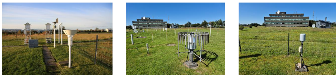
Mynd 43. Úrkomumælar í gamla mælireit. Sjá má mæla fyrir mannaða athugun (R1), vigtunarmæli (R2) og vippumæli (R3) án vindhlífar. Allir mælarnir eru með úrkomuop 1,5 m yfir jörðu. Ljósmyndir: Þórður Arason 7. ágúst 2024 og 30. september 2009 (mannaður).
