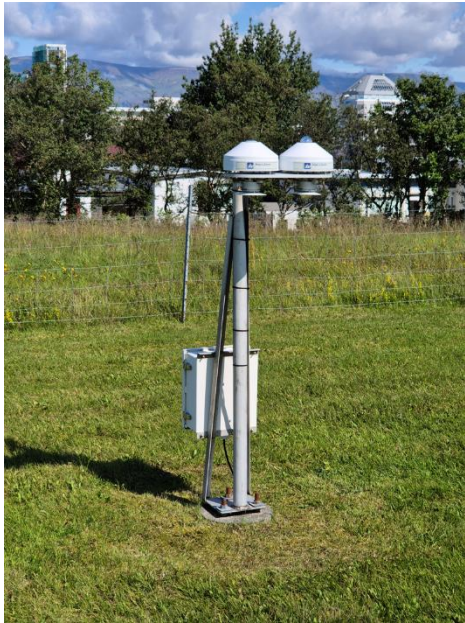
Mynd 57. Geislunarmælar í gamla og nýja mælireit. Gamli reitur er á vinstri mynd, nýi reitur á hægri mynd. Mældir eru fjórir þættir, langbylgjugeislun og stuttbylgjugeislun bæði frá himni og frá jörðu. Ljósmyndir: Þórður Arason, 7. ágúst 2024.
