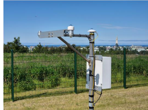
Mynd 57. Geislunarmælar í gamla og nýja mælireit. Gamli reitur er á vinstri mynd, nýi reitur á hægri mynd. Mældir eru fjórir þættir, langbylgjugeislun og stuttbylgjugeislun bæði frá himni og frá jörðu. Ljósmyndir: Þórður Arason, 7. ágúst 2024.
