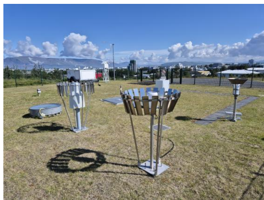
Mynd 44. Úrkomumælar í nýja mælireit. Sjá má vigtunarmæli (R5), vippumæli (R6), og mæli fyrir mannaða athugun (R4). Allir mælarnir eru með vindhlíf og úrkomuop í 1,5 m yfir jörðu. Auk þeirra má sjá uppgufunarpönnu og úrkomumæli með op við jörð. Ljósmynd: Þórður Arason 7. ágúst 2024.
