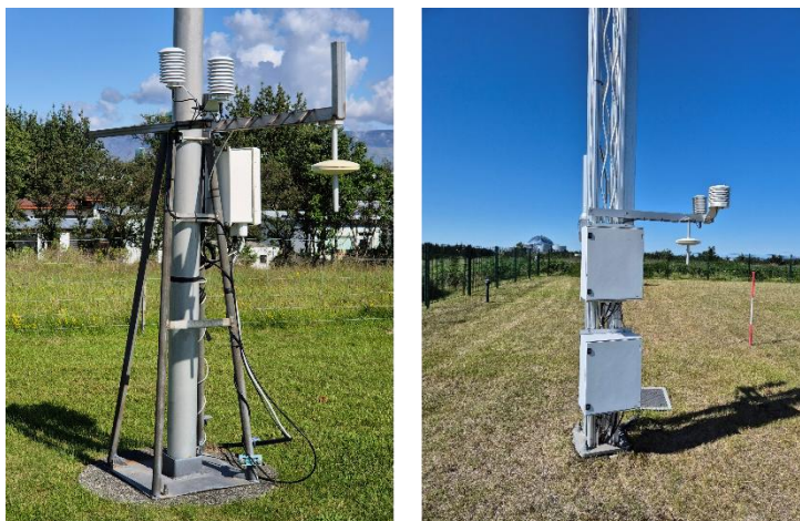
Mynd 8. Hita- og rakamælar á sjálfvirkum stöðvum. Sjá má stöðvar í gamla (vinstri) og nýja (hægri) mælireit. Mælarnir eru í 2 m hæð yfir jörðu og utan um þá eru geislunar- og úrkomuhlífar. Einnig sést loftinntak fyrir loftvogir, sem líta út eins og litlir láréttir diskar. Ljósmyndir: Þórður Arason, 7. ágúst 2024.
