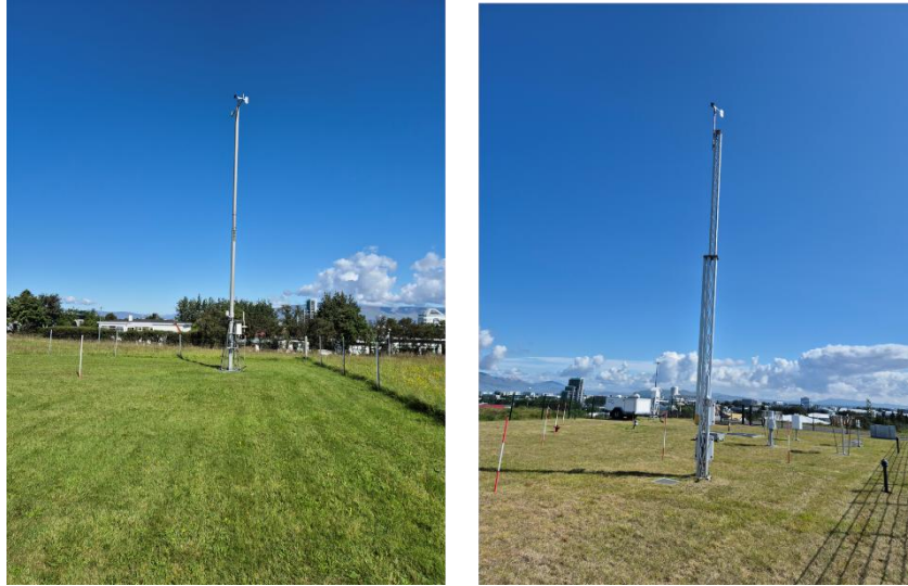
Mynd 25. Vindmælar í gamla og nýja mælireit. Vindmælarnir eru í 10 m hæð yfir jörðu og mæla 10 mín. meðalvindhraða, hæstu 3 s vindhviðu á síðustu 10 mín. og 10 mín. meðalvindátt. Ljósmyndir: Þórður Arason, 7. ágúst 2024.
