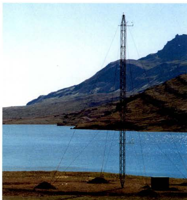
Mastur fyrir vind- og hitamælingar í Sómastaðagerði í Reyðarfirði (ljósm.: Flosi Hrafn Sigurðsson).
